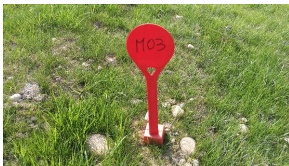
Foto 19: Punto per la verifica dei cedimenti - aprile.
