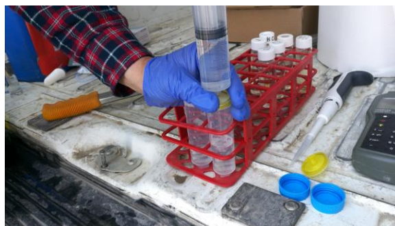
Foto 10: Campionamento acque di falda – filtrazione del campione
