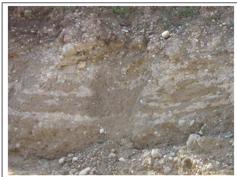
Scavo in località Custoza. Primo metro e mezzo di depositi morenici caratterizzati da strati ghiaiosi ad abbondante matrice limoso sabbiosa. Nell'occasione della foto gli strati a granulometria più fine risultavano umidi.
